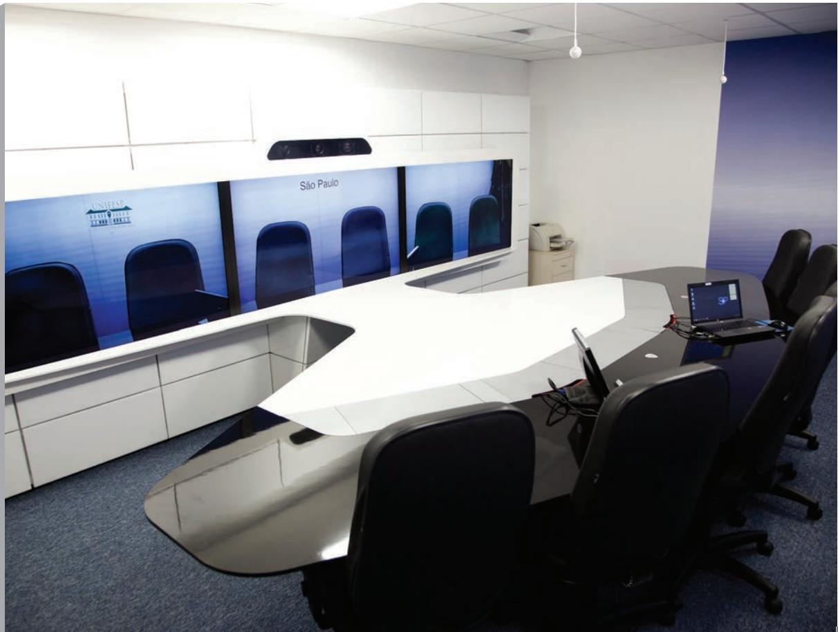
Cada uma delas está equipada com câmeras de alta definição (HD), posicionadas para a melhor cobertura do espaço assim que o sistema for iniciado, sem que os participantes precisem se preocupar com os ajustes dos equipamentos durante as reuniões.
