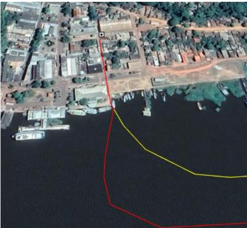
*Figura 8 - Visão detalhada planejada do BMH em Monte Alegre/PA, chegada do cabo submarino (amarelo) e saída para o próximo BMH (vermelho)*
