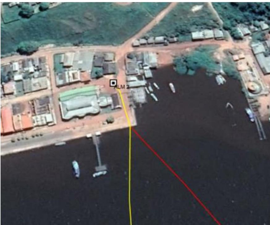
*Figura 6 - Visão detalhada planejada do BMH em Almeirim/PA, chegada do cabo submarino (vermelho) e saída para o próximo BMH (amarelo)*
