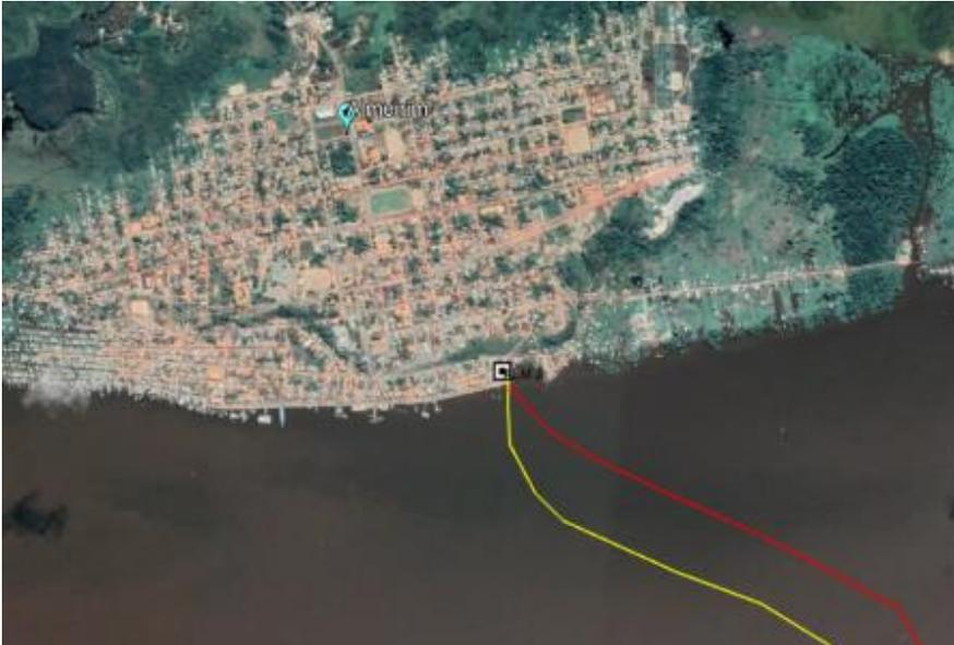
*Figura 5 - Visão geral planejada do BMH em Almeirim/PA, chegada do cabo submarino (vermelho) e saída para o próximo BMH (amarelo)*
