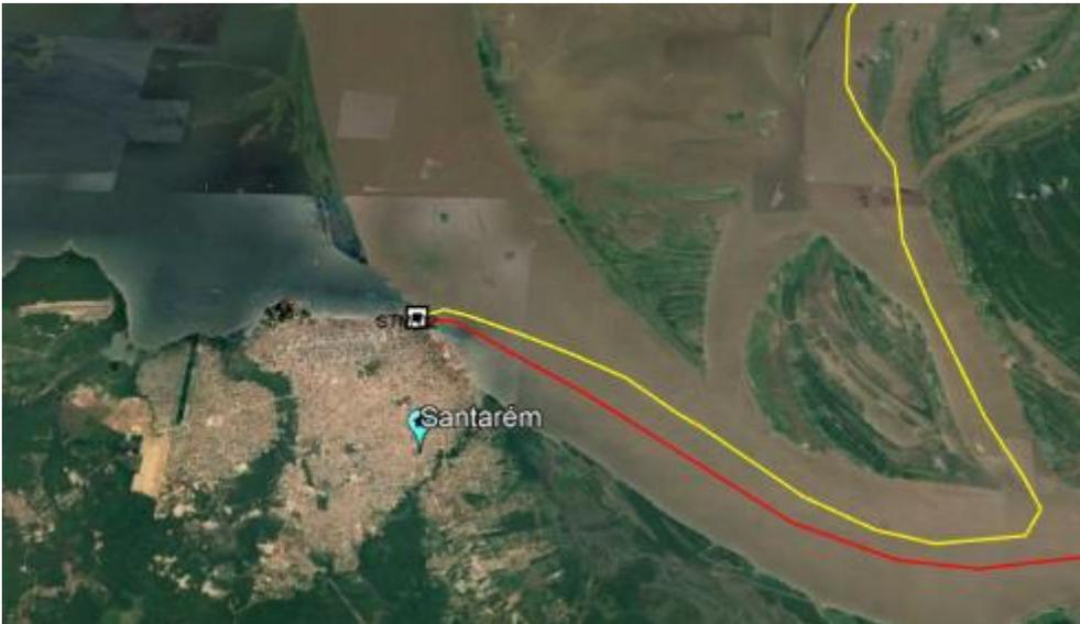
Figura 9 - Visão geral planejada do BMH em Santarém/PA, chegada do cabo submarino (vermelho) e saída para o próximo BMH (amarelo)
