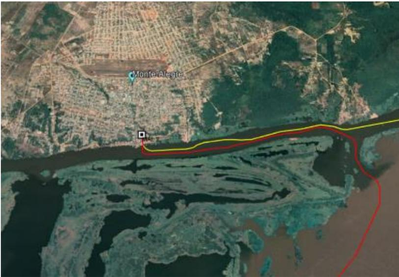
*Figura 27 - Visão geral planejada do BMH em Monte Alegre/PA, chegada do cabo submarino (amarelo) e saída para o próximo BMH (vermelho)*
