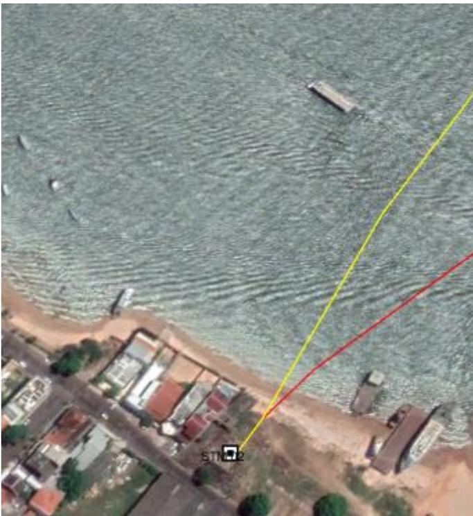
Figura 10 - Visão detalhada planejada do BMH em Santarém/PA, chegada do cabo submarino (vermelho) e saída para o próximo BMH (amarelo)
