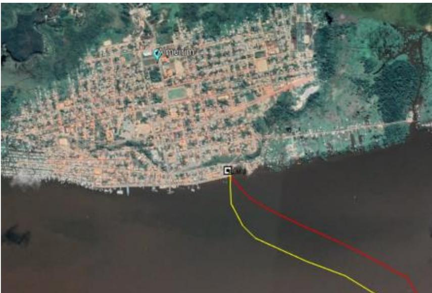
**FIGURA 8 - VISÃO GERAL PLANEJADA DO BMH EM ALMEIRIM/PA, CHEGADA DO CABO SUBMARINO (VERMELHO) E SAÍDA PARA O PRÓXIMO BMH (AMARELO)**
