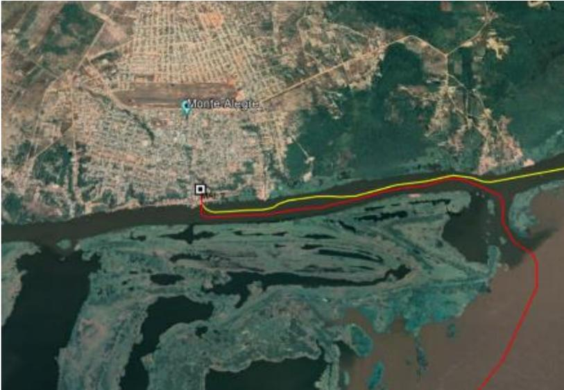
**FIGURA 7 - VISÃO GERAL PLANEJADA DO BMH EM MONTE ALEGRE/PA, CHEGADA DO CABO SUBMARINO (AMARELO) E SAÍDA PARA O PRÓXIMO BMH (VERMELHO)**
