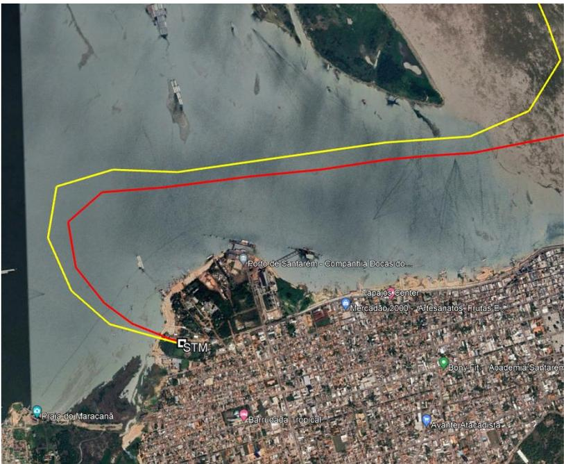
**FIGURA 8 - VISÃO GERAL PLANEJADA DO BMH EM SANTARÉM/PA, CHEGADA DO CABO SUBMARINO (VERMELHO) E SAÍDA PARA O PRÓXIMO BMH (AMARELO)**
