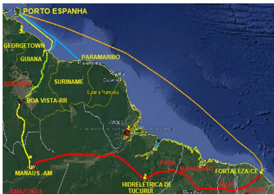
Figura 2 – Anel óptico através das regiões Nordeste e Norte, Oceano Atlântico, e Rota Óptica Boa Vista - Georgetown
