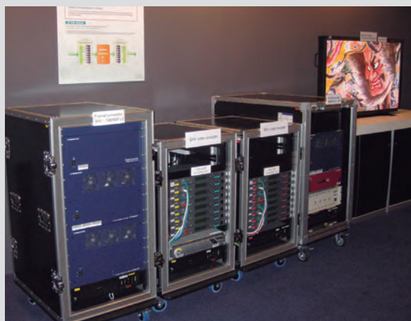
Fig. 3: Codec baseado em AVC (terceira geração)
